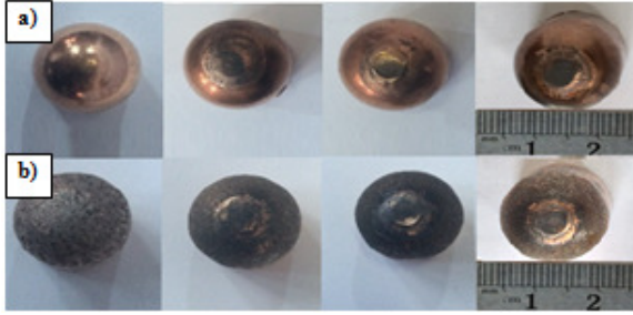
Şekil 8. 0-5-10-20 kaynak sonrası uç makro görüntüsü a) Cu-Cr-Zr elektrot b) TiC-Co kaplanmış elektrot
