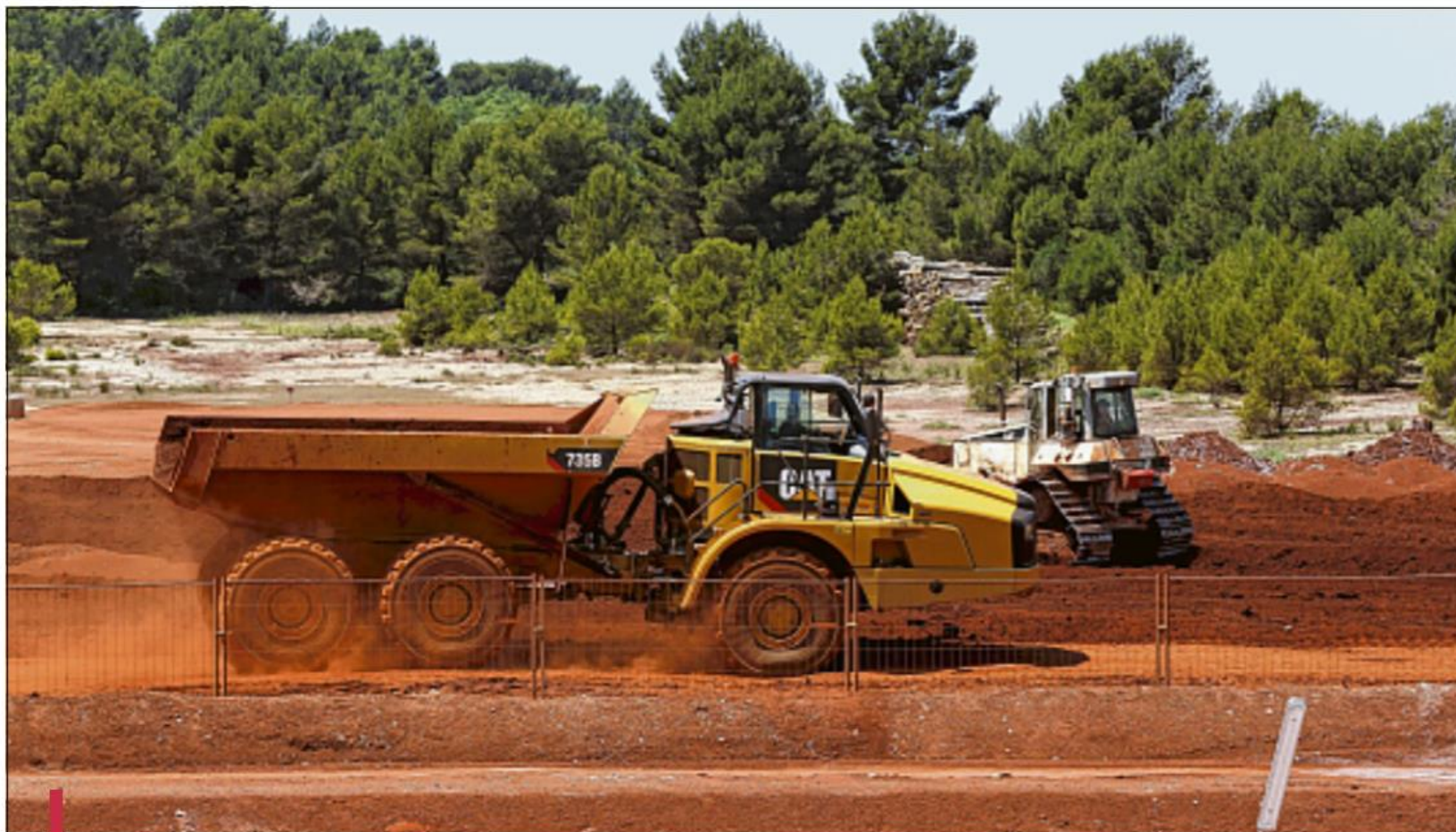
À la sortie du filtre-pressé, la bauxaline est épandue sur le plateau de Mange-Garri. Désormais, 300 000 tonnes/an. / PHOTO ARCHIVES SERGE MERCIER
