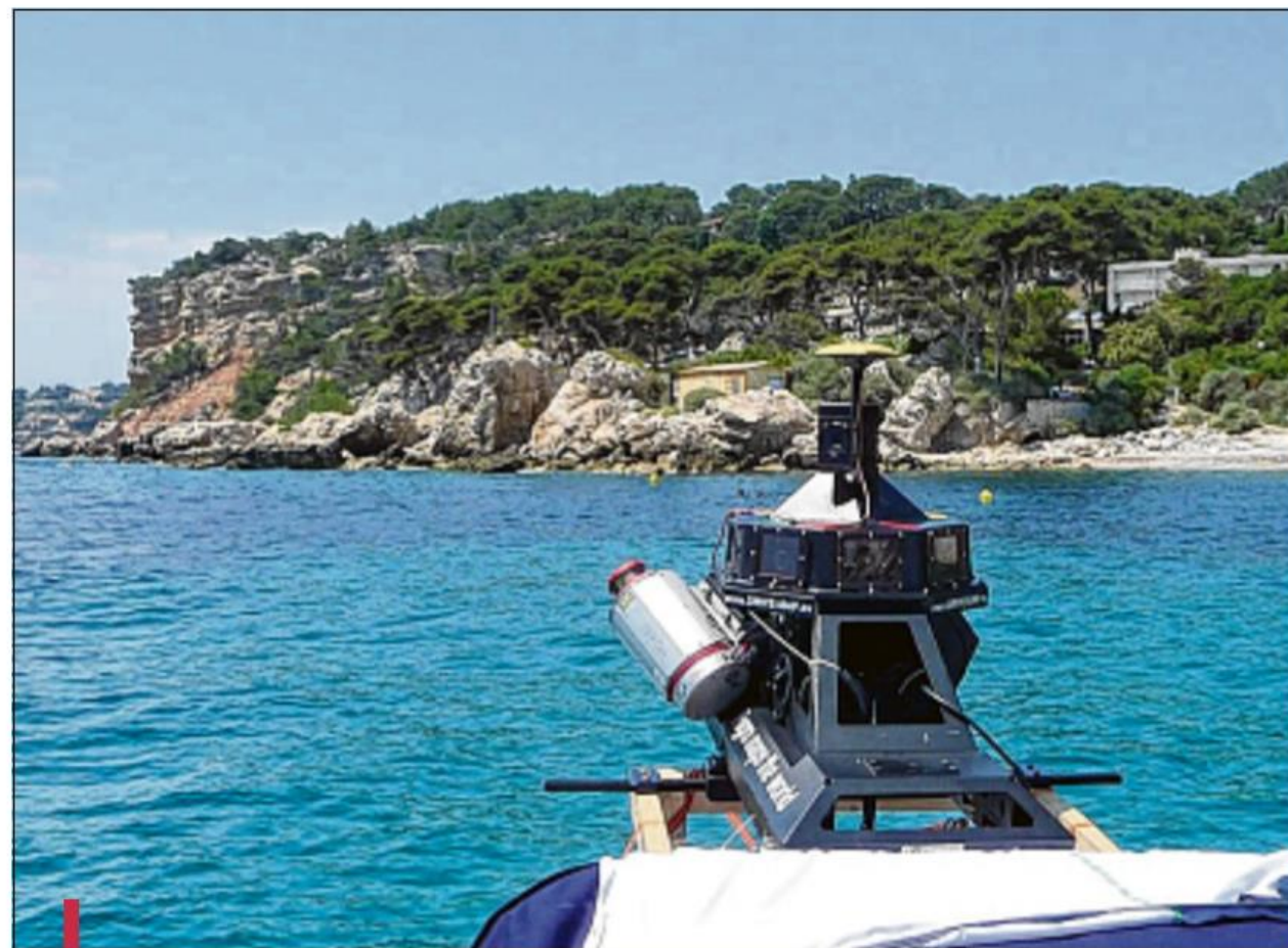
L'évaluation de l'érosion se fait avec un scan laser embarqué qui assure le suivi.
