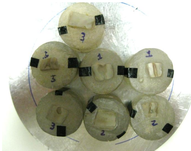
Figura 7 Espécimes incluídos em discos de PVC e metalizados em Ouro Paládio para observação em Microscópio Eletrônico de Varredura Quanta 600FEG (FEI Company).
