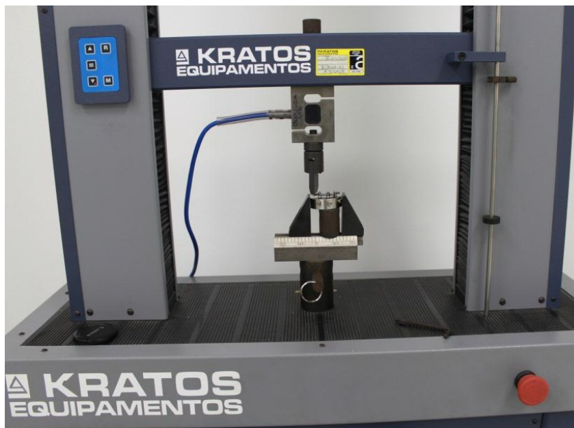
Figura 11 – Ensaio de flexão sendo realizado em Máquina de ensaios universais Kratos Série KE.
