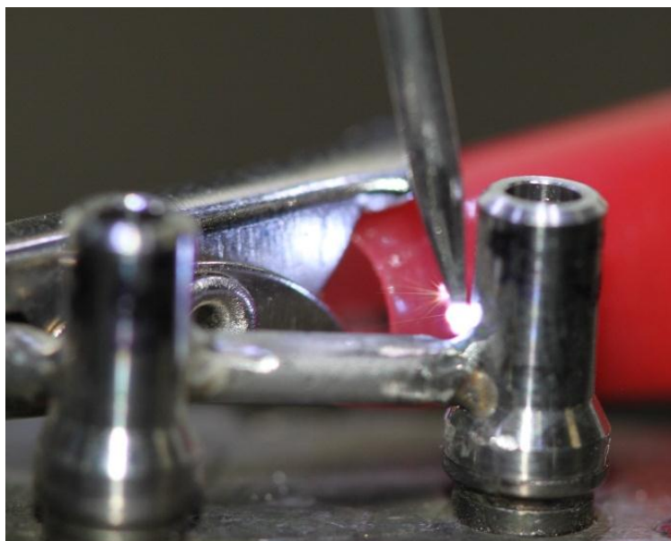
Figura 4 – Soldagem TIG do cilindro à barra justaposta, em toda sua circunferência.
