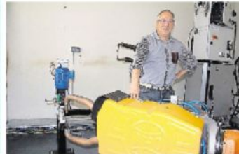
À Château-du-Loir, Philippe Chartrain avec l'une des pinces à souder robotisée d'Aro Welding Technologies. Cet outil est capable d'assembler une centaine d'éléments de tôlerie en 3 000 à 5 000 points de soudure.
