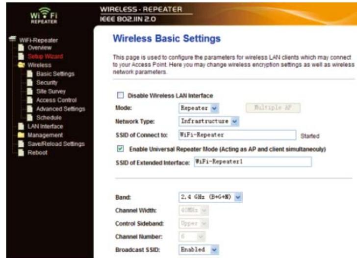
Sie können hier die für die Konfiguration erforderlichen, minimalen Einstellungen vornehmen, wie .B.SSID (Name des kabellosen Netzwerks) und WLAN Kanal. Der WLAN AP Modus kann mit minimalen Einstellungen eingerichtet werden.
