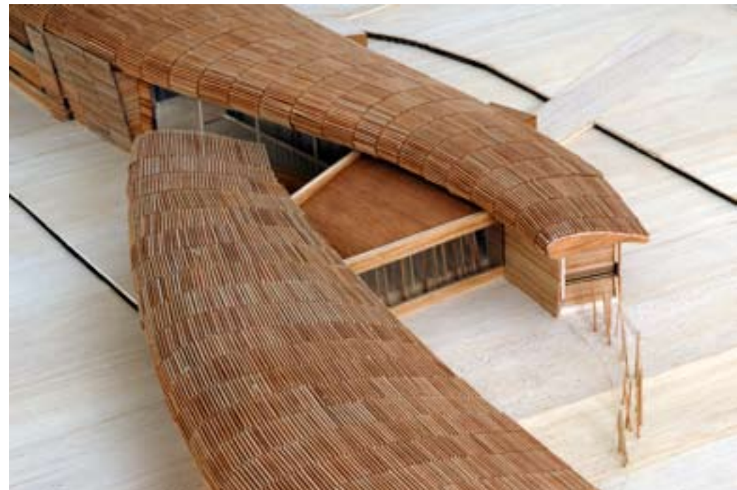
Modelos de detalles constructivos relación de cerchas, impermeabilización y entablado de cubierta. Vista volumétrica del lobby del hotel.
