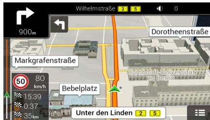
Un champ se trouve dans l'angle supérieur gauche et affiche la prochaine manœuvre. Le type de manœuvre (virage, rond-point, sortie d'autoroute, etc.) ainsi que sa distance par rapport à la position actuelle sont affichés.
