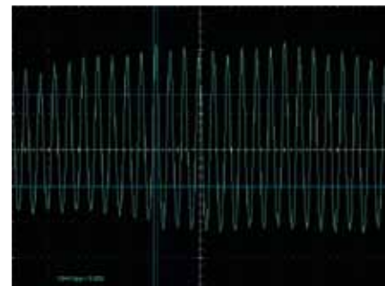
Spannung am Sensor bei rund plus 40 Grad Celsius (ebenfalls Sensor vom Steuergerät abgeklemmt)
