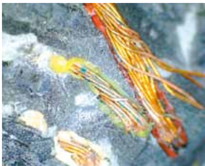
Sensor-Schadenbilder: Eintritt von Feuchtigkeit in den Sensor über die einzelnen Leitungen,...
