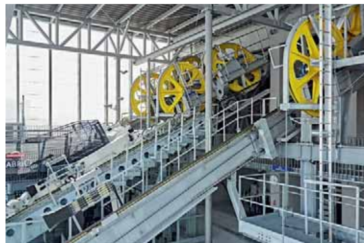
Die Seile der «Cabrio»-Bahn sind viermal schwerer als jene der vorherigen Bahn.
