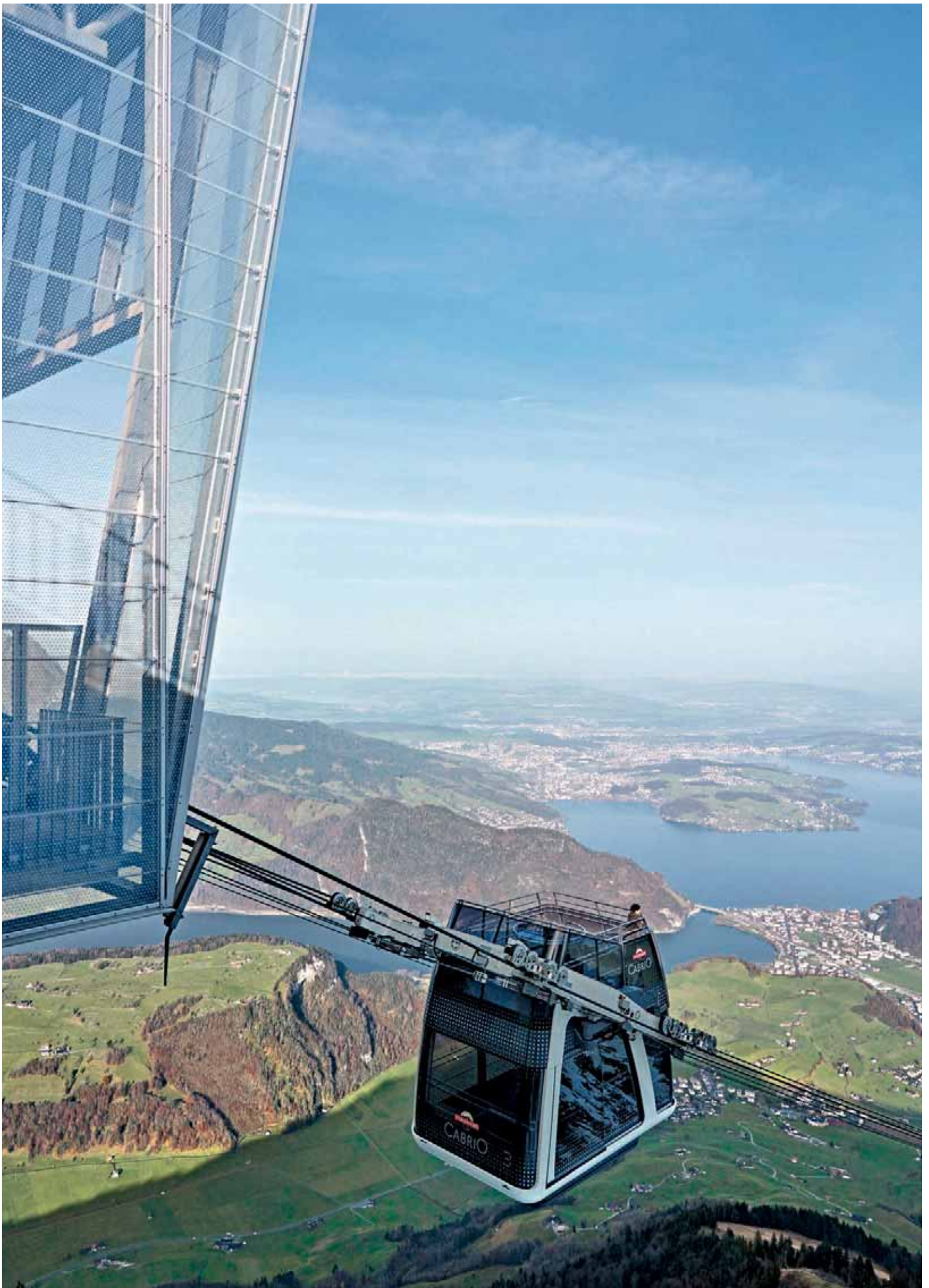
«Cabrio» am Stanserhorn mit Blick auf den Vierwaldstättersee: Dreissig Passagiere haben auf der fahrenden Terrasse Platz, weitere dreissig unter Deck.
