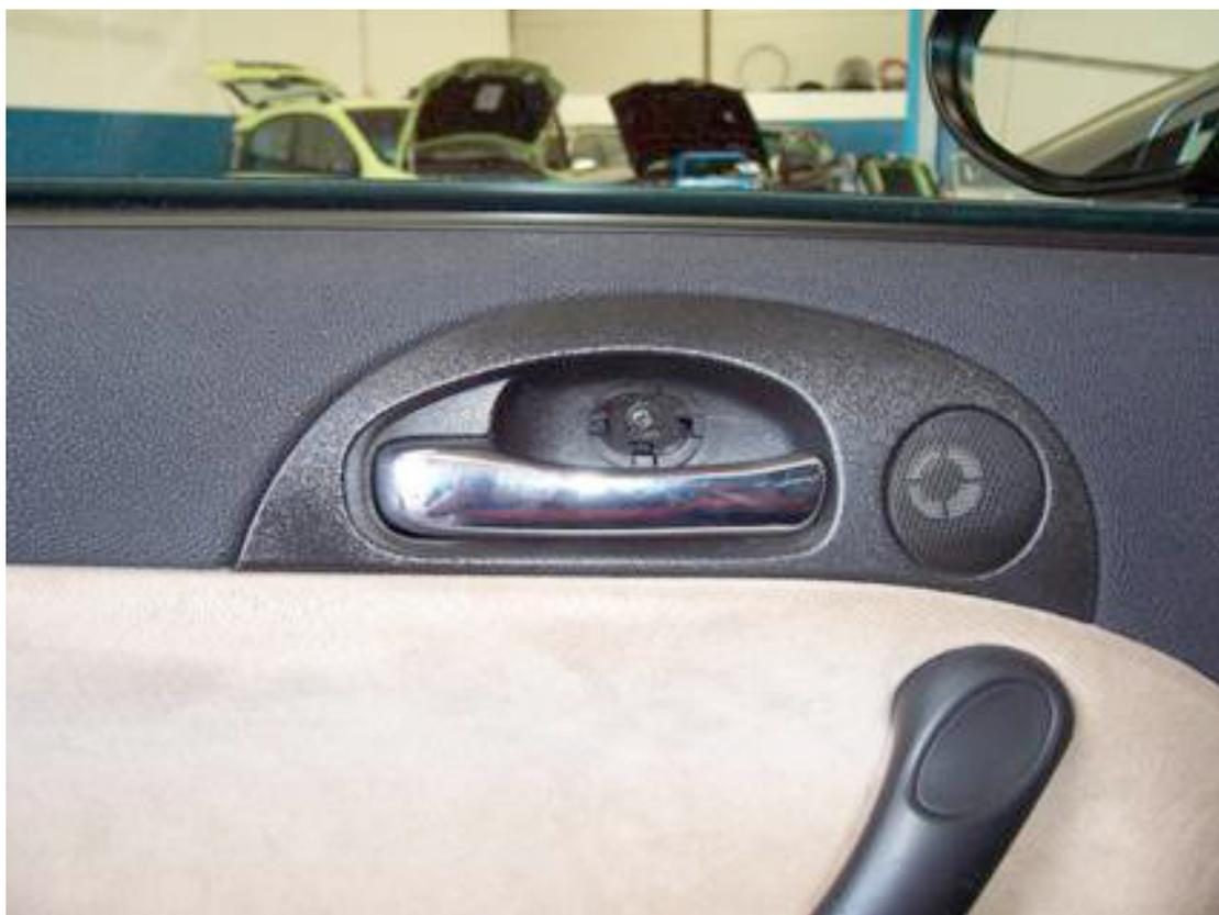
**SVITARE LA VITE CHE TIENE FISSATA TUTTA LA STRUTTURA IN PLASTICA ALLA PORTIERA**
