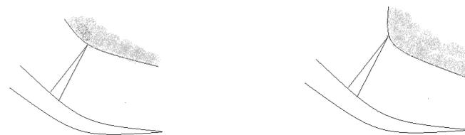
*1 la pointe doit être orthogonale à la surface à éperonner, sinon glissement sans perforation.*
