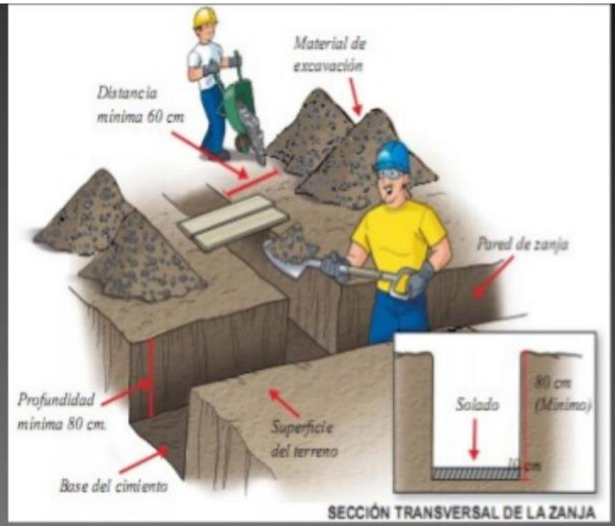
Una vez terminada la excavación de las zanjas, se procederá a realizar los solados. Éstos nos permitirán contar con una superficie nivelada, rugosa y compacta para trazar y ubicar las columnas adecuadamente.
