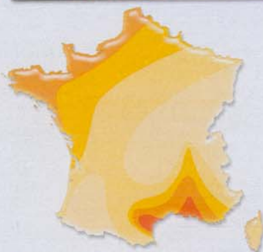
La carte des vents en France. Selon les modèles, une vitesse de 3 à 5 mètres par seconde est nécessaire pour faire fonctionner une éolienne.
