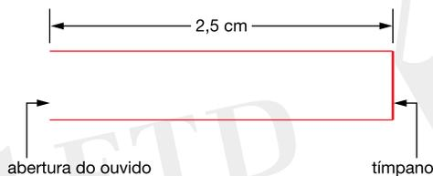
A frequência fundamental do som que forma ondas estacionárias nesse tubo é: (Dado: velocidade do som no ar,  $v = 340$  m/s.)
