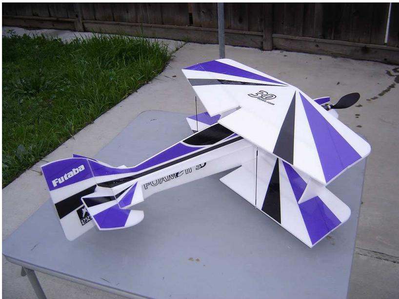
Cortado em CNC de fio quente é fácil de montar e requer pouca prática para isso.
